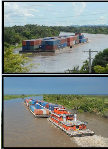
Imagen 12- Cada convoy de estos, moviliza hasta 250 TEU, equivalentes a 5000 ton, equivalentes al 50% de la carga típica de un tren en el Cerrejón. Imagen en http://godues.wordpress.com
