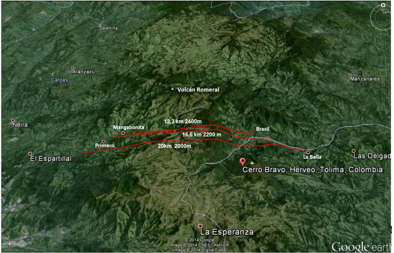
Alternativas de tunelado de la Cordillera Central por el Norte de Cerro Bravo. Como referente, el Túnel de La Línea cruza rocas menos competentes a 2500 metros de altitud (msnm).
