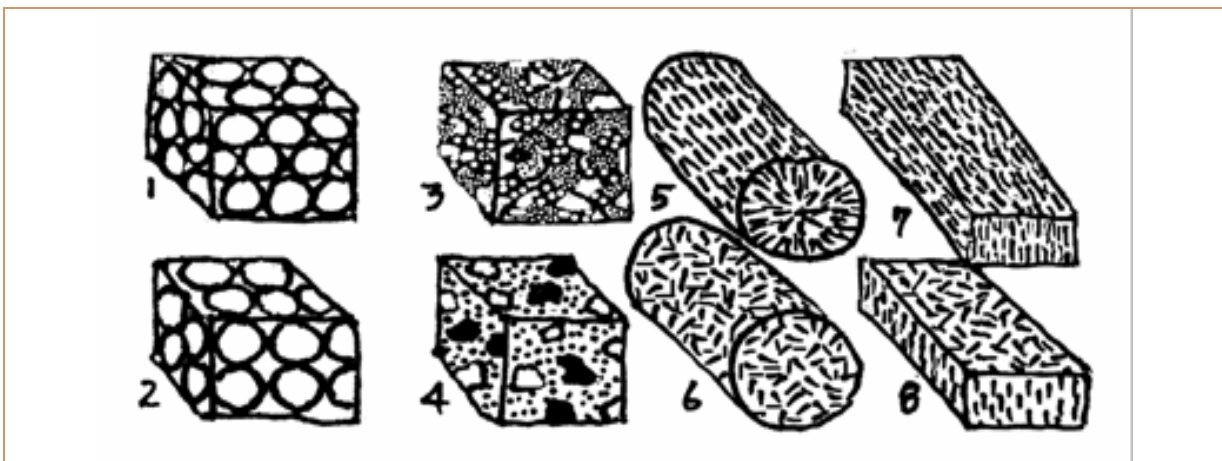
Figura 85. Acerca de las fábricas texturales. 1 Granular densa homogénea e isotrópica. 2 Granular no densa e isotrópica. 3 Granular clasto-soportada heterogénea e isotrópica. 4 Granular matriz-soportada e isotrópica. 5 Laminar orientada y alotrópica (ortotrópica). 6 Fibrosa no orientada e isotrópica. 7. Fibrosa orientada y alotrópica (ortotrópica). 8. Laminar alotrópica. Curso de M. de Rocas. Álvaro Correa Arroyave. U. Nal de C.
